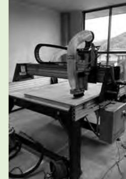
秩父地域の某所に導入された大型CNC加工機「Shopbot」をお借りしてお試し加工中の写真です。サブロク板も加工できる大型サイズの加工機なのでDIY好きの様々なニーズに答えてくれそうです。(御田)
